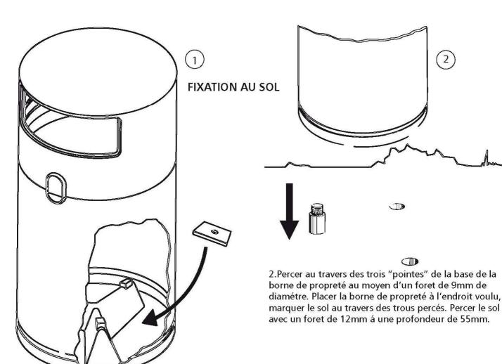
1.Placer la borne de propreté sur les boulons au sol. Placer les pattes d'attache fournies sur les boulons qui passent au travers.
